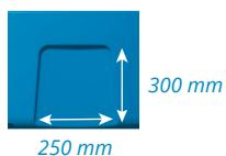
8 amores de passage de fourches permettant de faciliter la manipulation et le déplacement à vide de la cuve
